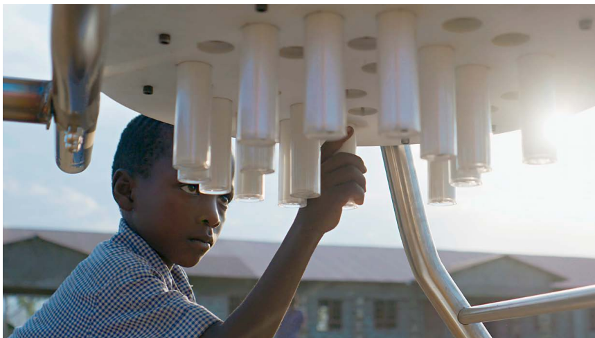
Wenn die Kinder morgens zur Schule kommen, hängen sie eine portable Batterie zum Laden ans Euter der Solarkuh.
