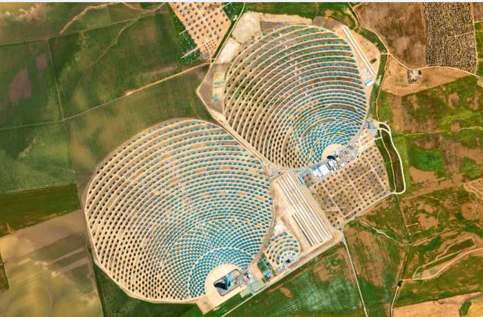
Sevilla Solucar: Hunderte Spiegel reflektieren die Sonneneinstrahlung bei Sevilla auf die Spitze eines Turms und produzieren mit einer Hitze von 1000 °C elektrische Energie. © eoVision/DigitalGlobe, 2011, distributed by e-GEOS
