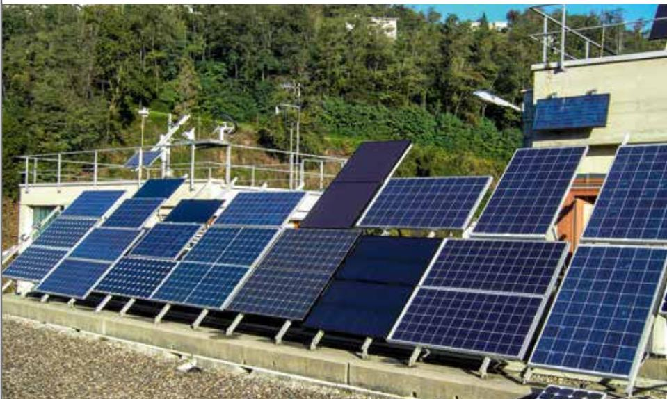
Im neuen Teststand auf dem Dach der Hochschule wird die Langzeit-Performance von verschiedenen Solarzellen-Modellen untersucht.
